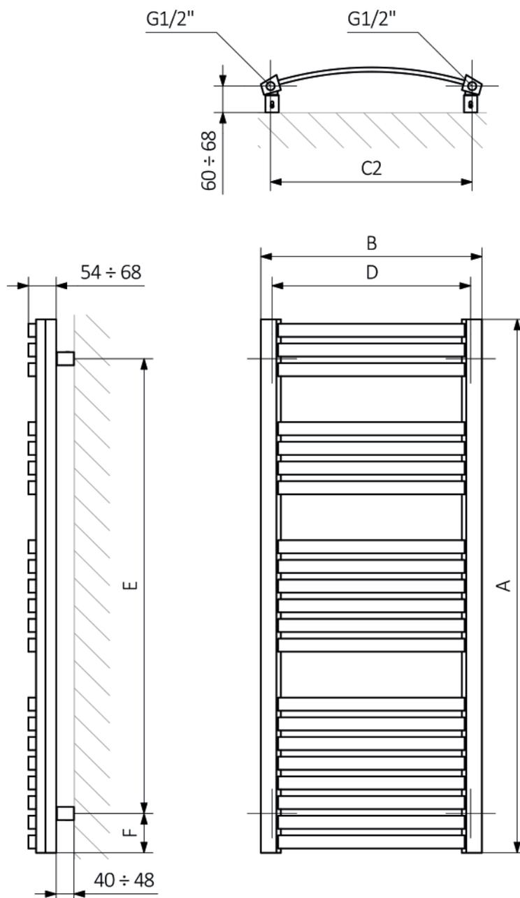
A - hauteur B - largeur C1-C5 - écartement des raccordements D - écartement des consoles en horizontal E - écartement des consoles en vertical F - distance entre l'axe inférieur des fixations et le bord inférieur du collecteur
