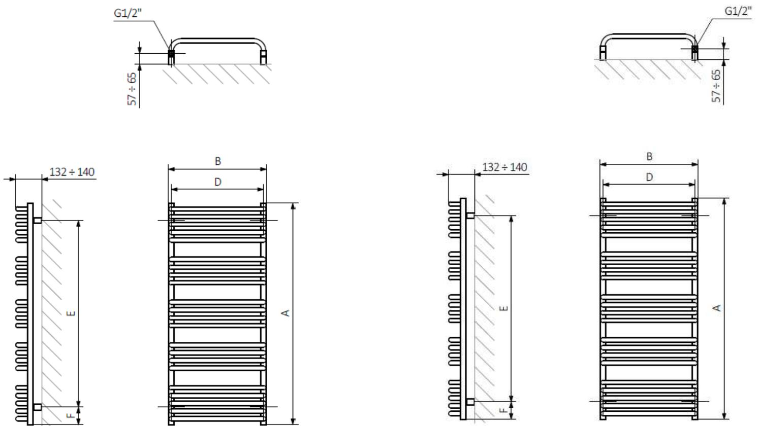
A - hauteur B - largeur C1-C5 - espacement des connexions D - distance entre les fixations à l'horizontale E - distance entre les dispositifs en F verticale - distance entre l'axe inférieur des fixations et le bord inférieur du collecteur
