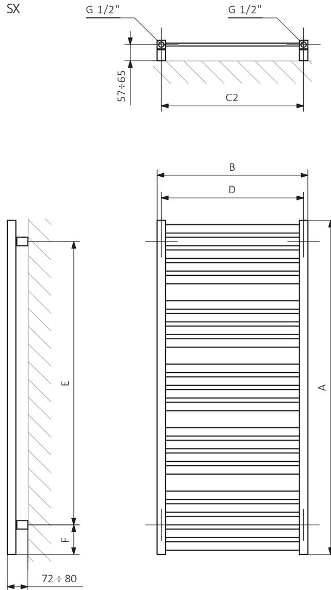
A - hauteur B - largeur C1-C5 - espacement des connexions D - distance entre les fixations à l'horizontale E - distance entre les dispositifs en F verticale - distance entre l'axe inférieur des fixations et le bord inférieur du collecteur
