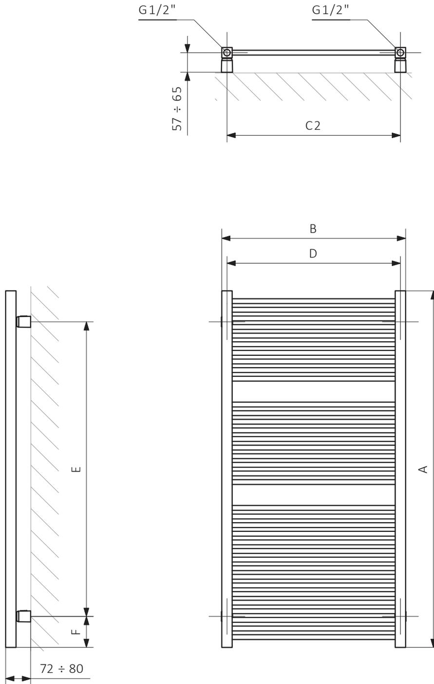
A - hauteur B - largeur C1-C5 - espacement des connexions D - distance entre les fixations à l'horizontale E - distance entre les dispositifs en F verticale - distance entre l'axe inférieur des fixations et le bord inférieur du collecteur
