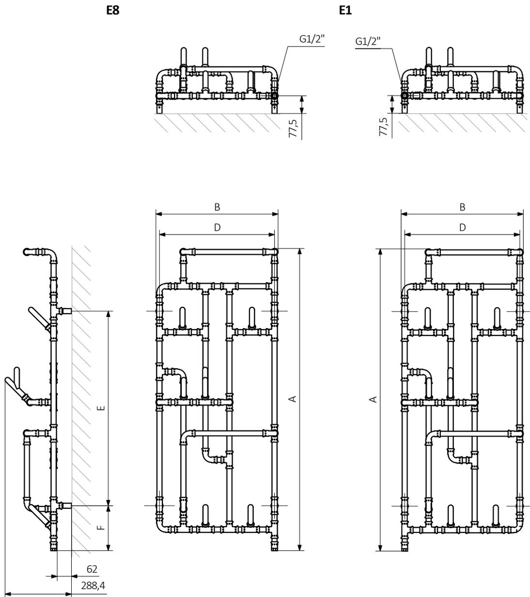
A - hauteur B - largeur C1-C5 - espacement des connexions D - distance entre les fixations à l'horizontale E - distance entre les dispositifs en F verticale - distance entre l'axe inférieur des fixations et le bord inférieur du collecteur
