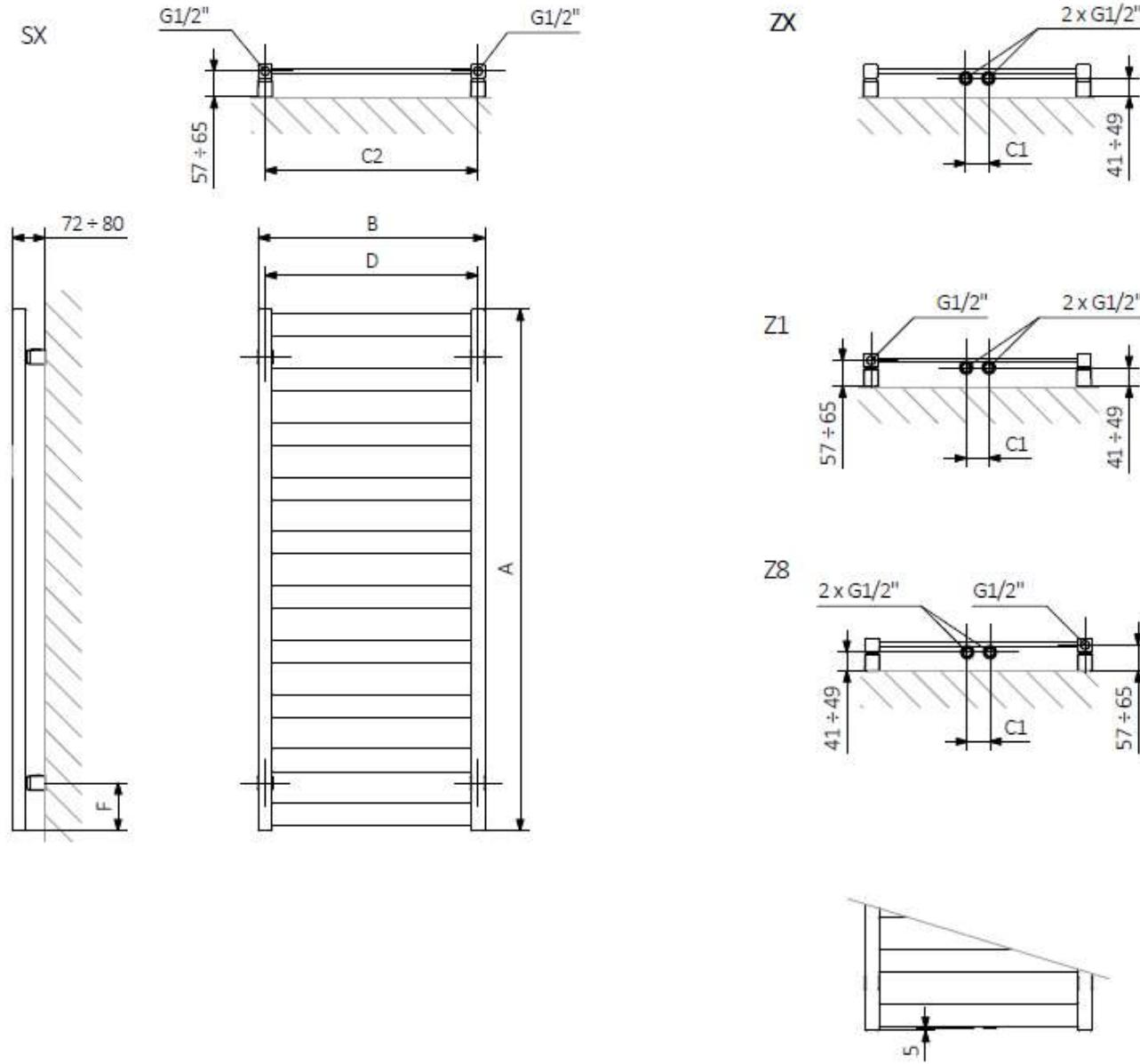
A - hauteur B - largeur C1-C5 - espacement des connexions D - distance entre les fixations à l'horizontale E - distance entre les dispositifs en F verticale - distance entre l'axe inférieur des fixations et le bord inférieur du collecteur
