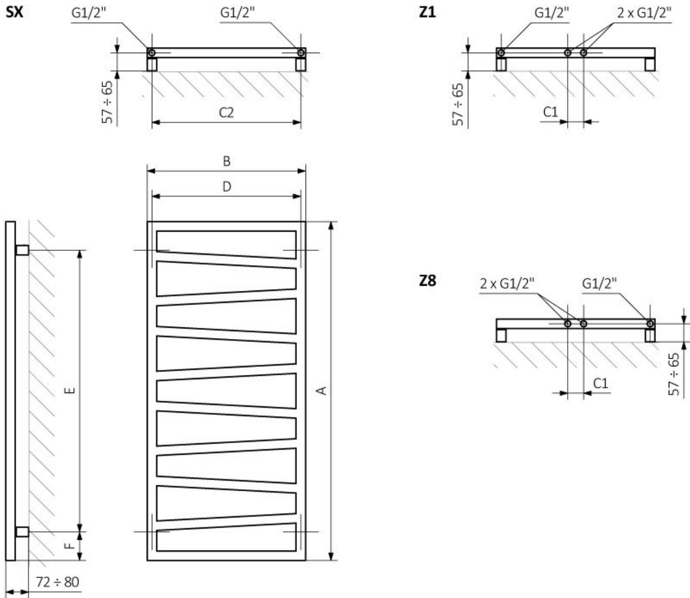
A - hauteur B - largeur C1-C5 - espacement des connexions D - distance entre les fixations à l'horizontale E - distance entre les dispositifs en F verticale - distance entre l'axe inférieur des fixations et le bord inférieur du collecteur
