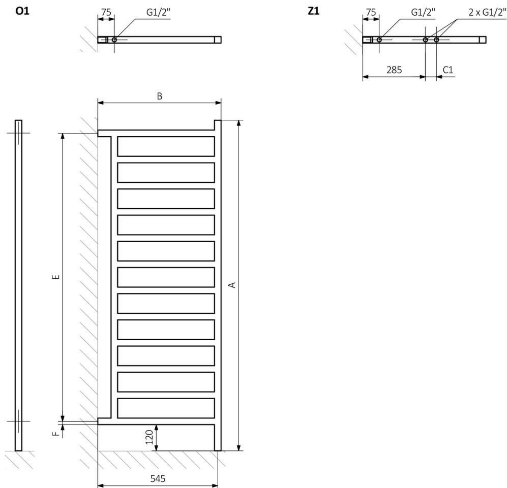
A - Hauteur / B - Largeur / C1-C5 - Ecartement des raccordements / D - Ecartement des consoles en horizontal / E - Ecartement des consoles en vertical / F - Distance de l'axe de la console inférieure au bord inférieur du collecteur
