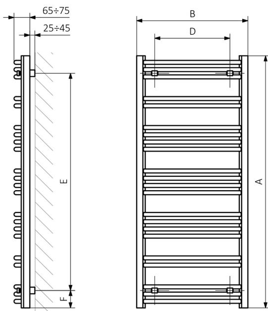
A – hauteur B – largeur C1-C5 – écartement des raccordements D – écartement des consoles en horizontal E – écartement des consoles en vertical F – distance de l'axe de la console inférieure au bord inférieur du collecteur
