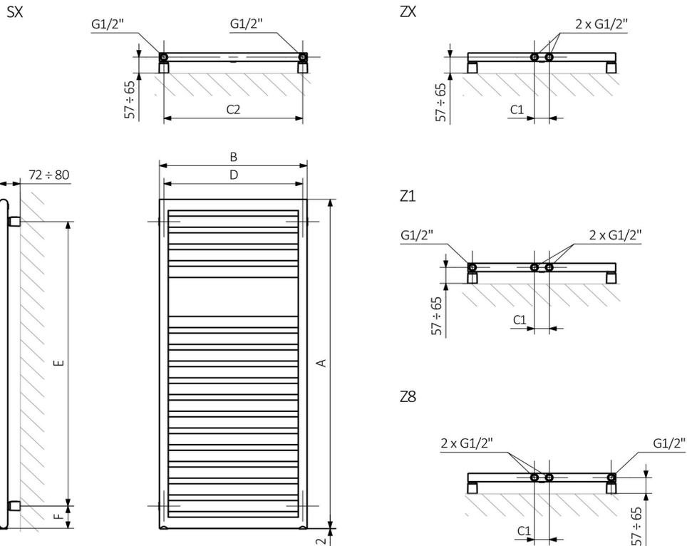
A - Hauteur / B - Largeur / C1-C5 - Ecartement des raccords / D - Ecartement des consoles en horizontal / E - Ecartement des consoles en vertical / F - Distance de l'axe de la console inférieure au bord inférieur du collecteur
