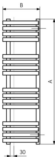
A – hauteur B – largeur C1-C5 – écartement des raccordements D – écartement des consoles en horizontal E – écartement des consoles en vertical F – distance de l'axe de la console inférieure au bord inférieur du collecteur
