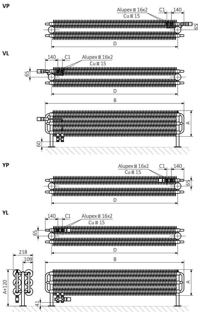
A - Hauteur / B - Largeur / C1-C5 - Ecartement des raccords / D - Ecartement des consoles en horizontal / E - Ecartement des consoles en vertical / F - Distance de l'axe de la console inférieure au bord inférieur du collecteur
