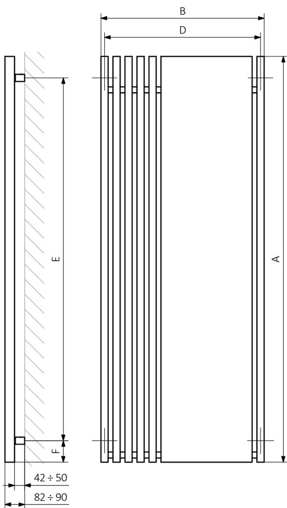
A – hauteur B – largeur C1-C5 – écartement des raccordements D – écartement des consoles en horizontal E – écartement des consoles en vertical F – distance de l'axe de la console inférieure au bord inférieur du collecteur
