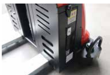
Accès à la batterie via trappe latérale
