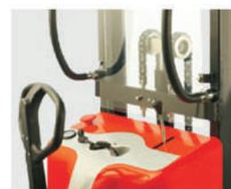
Précision de l'élévation et de la descente accrue grâce à l'utilisation d'un distributeur. Commutateur de coupure automatique de la batterie pour éviter les utilisations non autorisées.
