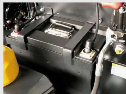
Le gerbeur PSE13NPRO est équipé d'une batterie Li-ion 24V / 100 Ah **LifePO4** sans entretien et un nombre très élevé de cycles de charge / décharge pendant la durée de vie.
