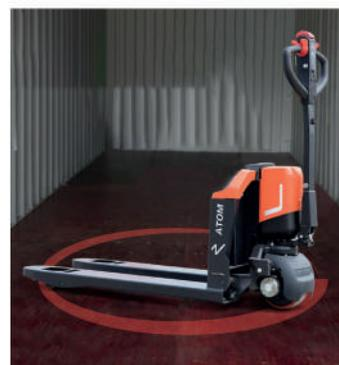
Le nouvel ATOM est équipé de série d'un système lui permettant de se déplacer avec le timon à la verticale (90°). Idéal pour les espaces restreints (ascenseurs, allées étroites...).
