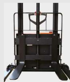
Le gerbeur PSE12NSL est équipé d'une batterie LiFePO4 24V/60Ah de type Li-ion, sans entretien, avec une charge rapide et un nombre de cycles de charge/décharge très élevé.
