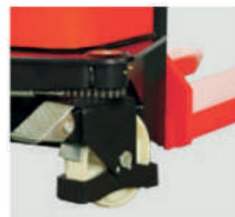
Protezione supplementare dei piedi dell'utente sulle ruote diretrici e freno meccanico di di parcheggio di serie.
