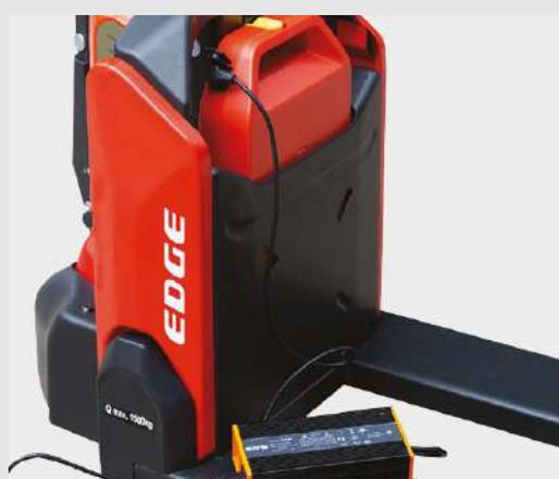
**Presa di ricarica direttamente sul cofano della batteria**
