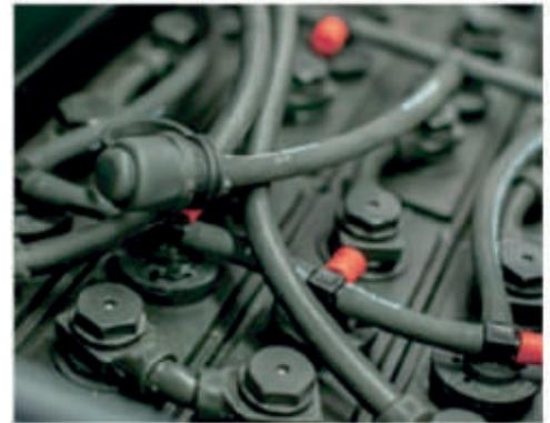
**Riempimento centralizzato della batteria**
