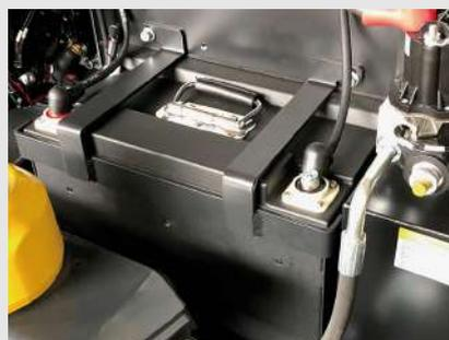
Il carrello elevatore PSE13NPRO è dotato di una batteria Li-ion 24 V / 60Ah LifePO4 senza manutenzione con ricarica rapida e un numero molto elevato di cicli di carica/scarica durante la vita utile.
