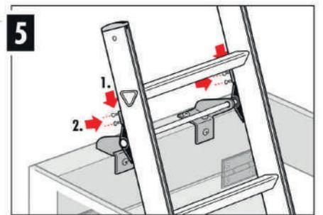
Befestigen Sie die Leiter in der richtigen Stellung zum Hinaufsteigen beim Schieben die beiden schwarzen Kunststoffanschlüsse nach unten, bis Sie das obere Ende der Stange erreichen. Ziehen Sie die 4 Schrauben fest. So können Sie die Leiter entsprechend Ihrer Raumhöhe anpassen.
