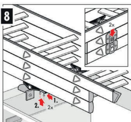
Die Leiterteile müssen zusammengeklappt werden. Bitte passen Sie auf, dass sich die Sicherheitsriegel in der verriegelten Stellung befinden. Schieben Sie die ganze Leiter in den Dachboden. Schieben Sie beide schwarzen Kunststoffstopfen nach oben, bis Sie das untere Ende der Stange erreichen. Ziehen Sie die 4 mitgelieferten Schrauben fest.
