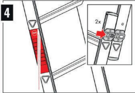
Klappen Sie die Leiter bis zum Boden heraus. Die Sicherheitsriegel müssen sich in der verriegelten Position befinden. Passen Sie die Stellung der Leiter mithilfe der Winkelanzeige auf dem Aufkleber an der Seite der Leiter an (siehe Abbildung in der Mitte).
