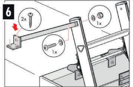
Befestigen Sie mit den mitgelieferten Beschlägen den Schwenkarm in herausgeklappte Stellung an der Leiter und am Dachboden.
