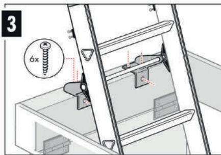
Die Befestigungswinkel müssen mit den 6 mitgelieferten Schrauben am Rahmen verschraubt werden. Stellen Sie sicher, dass die Winkel genau an jedem Ende der Stange befestigt werden, dass die Leiter in der Mitte der Öffnung befestigt ist und dass kein Hindernis die Öffnung behindert.
