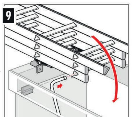
Verwenden Sie das Ende des Handlaufs, um die Leiter ein- oder auszuklappen, indem Sie es in ein Sprossenloch einführen.
